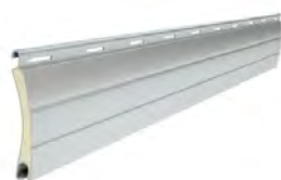
PA 37 wysokość profilu: 37mm grubość: 8,5mm
